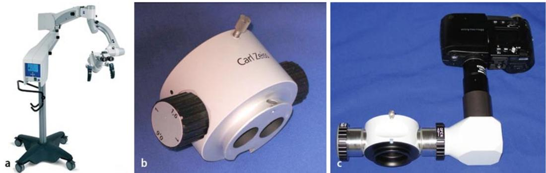
1 a Dentalmikroskop ProErgo, Fa. Zeiss, Oberkochen; b ein Vergrößerungswechsler 3-fach bis Faktor 1,6 ermöglicht eine Steigerung der Vergrößerungsleistung auf etwa 30-fach; c Strahlenteiler 50:50 mit angeschlossener digitaler Fotokamera
