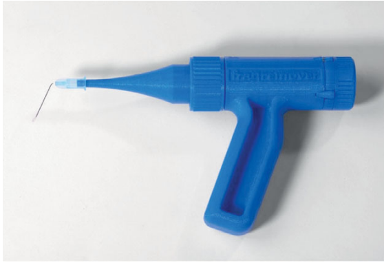
Abb. 1 Der „FragRemover“ erleichtert die Anwendung der Loop-Technik. Durch eine dünne, flexible Kanüle ist bereits ein feiner Draht geführt, der eine Schlaufe zur Fassung des Fragmentkopfs bildet. Durch Zusammenziehen der Schlaufe und koronalen Zug des gesamten Systems können Fragmente entfernt werden.
