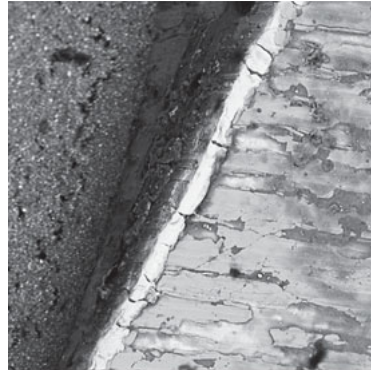
Abb. 7 Entlang der Schneidekante ist keine Beschichtung mehr vorhanden. Der Grat weist typische Risse aus dem Herstellungsprozess auf.
