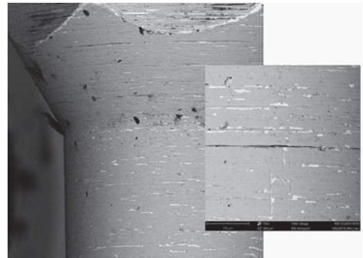
Abb. 10 Auf der mechanisch unbenutzten Fläche liegt die TiN-Beschichtung unvollständig mit vereinzelt Einrissen vor.
