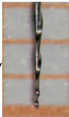
Abb. 5b Vergrößerte Darstellung der verformten und frakturierten Nickel-Titan-Feile.
